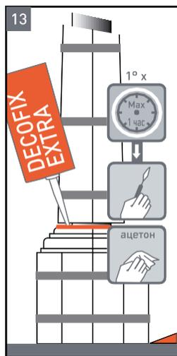
**13** Нанесите клей для стыков «Decofix EXTRA» на верхнюю часть основания (базы) для окончательного соединения всех элементов. Удалите излишки клея со стыка, затем протрите ацетоном.
