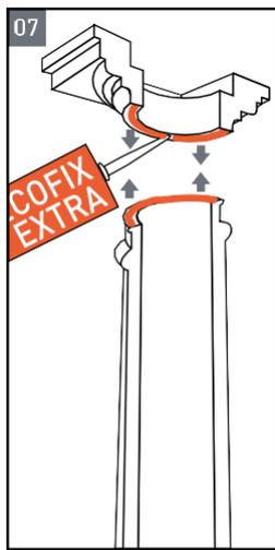
**7** С помощью клея для стыков «Decofix EXTRA» соедините полукапиталь с полуколонной. Клей наносите с избытком, заполняя всю плоскость стыка.
