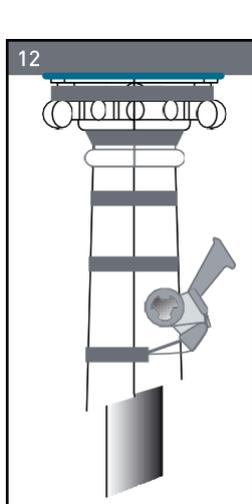
**12** Места стыков зафиксируйте скотчем или скобами при помощи мебельного степлера.
