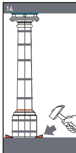
**14** Зафиксируйте по кругу изделие в распор с помощью клиньев.
