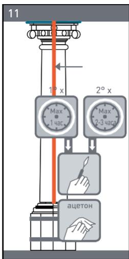
**11** Удалите излишки клея со стыка, затем протрите ацетоном.
