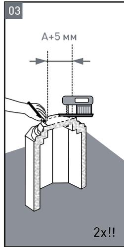
**3** Вырежьте внутреннюю часть основания (базы) полуколонны по размерам несущей конструкции +5 мм.
