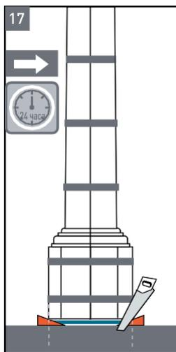
**17** После полного высыхания клея (24 часа) обрежьте выступающие части клиньев с помощью ножовки.
