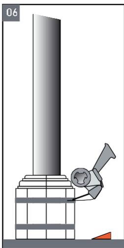
**6** Места стыков зафиксируйте скотчем или скобами при помощи мебельного степлера.
