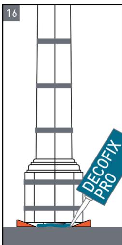
**16** Заполните пустоты между полом и основанием (базой) колонны монтажным клеем «Decofix Pro».
