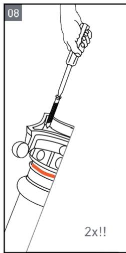
**8** Соедините детали между собой, дополнительно скрепив их саморезами.
