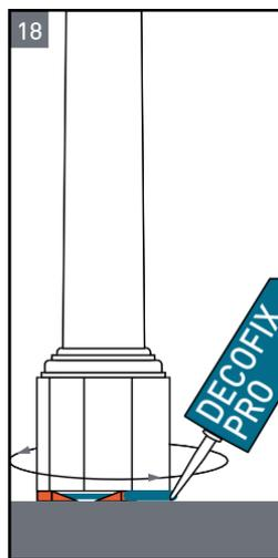
**18** После полного высыхания клея «Decofix EXTRA», не ранее чем через 24 часа, вытащите скобы (снимите скотч), удалите излишки клея, срезав их ножом. Прощлакните изделие в местах всех соединений. После полного высыхания шпаклевки зашкурьте места соединений мелкозернистой шкуркой.
