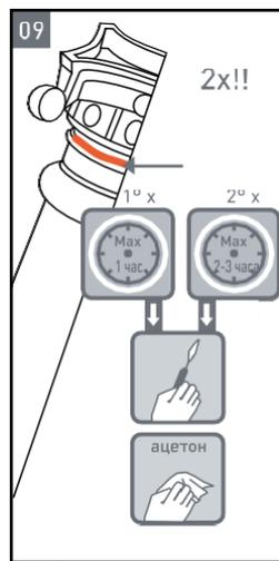
**9** Удалите излишки клея со стыка, затем протрите ацетоном.
