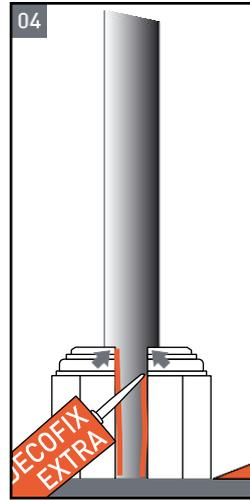
**4** Обрамите несущую конструкцию и соедините готовые детали между собой при помощи клея для стыков «Decofix EXTRA». Клей наносите с избытком, заполняя всю плоскость стыка.
