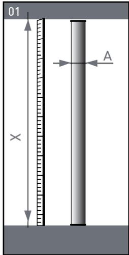
**1** Сделайте разметку с помощью отвеса или уровня в том месте, где планируется установка изделия, замерьте диаметр несущей конструкции.
