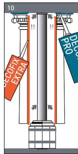
**10** Нанесите монтажный клей «Decofix Pro» на верхнюю часть изделия для последующего крепления к потолку. Обработайте несущую конструкцию и соедините готовые детали между собой при помощи клея для стыков «Decofix EXTRA». Клей наносите с избытком, заполняя всю плоскость стыка.
