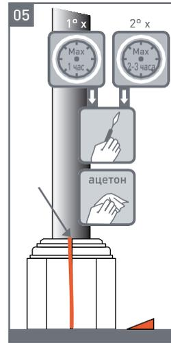
**5** Удалите излишки клея со стыка, затем протрите ацетоном.
